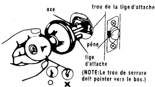
Insérez le bouton ou le bec-de-cane avec l'axe dans le verrou, en vous assurant que les tiges d'attaches sont bien placées dans leurs trous. Pressez contre la porte.
