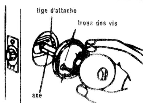
Installez le bouton intérieur et la rosette en plaçant l'axe dans le trou de la came et en alignant les tiges d'attache vis-à-vis leurs trous. Pressez contre la porte insérez les vis et serrez fermement.
