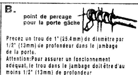
Perce un trou de 1" (25.4mm) de diamètre par 1/2" (13mm) de profondeur dans le jambage de la porte. Attention: Pour assurer un fonctionnement adéquat, le trou dans le jambage doit être d'au moins 1/2" (13mm) de profondeur
