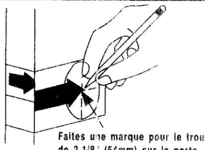
Marquez le centre du trou sur la porte à l'aide du repère sur le gabarit pour une distance d'entrée de 2 3/8" (60mm) ou 2 3/4" (70mm). NOTE: La distance d'entrée sur la porte doit correspondre à celle du verrou.
