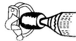
Percez un trou de 2 1/8" (54mm) (selon la serrure) de bord en bord de la porte. Il est recommandé de percer à partir des deux côtés pour prévenir le fendillement
