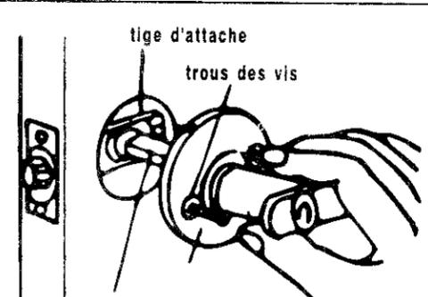
Installez le bec-de-cane intérieur et la rosette en plaçant l'axe dans le trou de la came et en alignant les tiges d'attache vis-à-vis leurs trous. Pressez contre la porte. Insérez les vis et serrez fermement.
